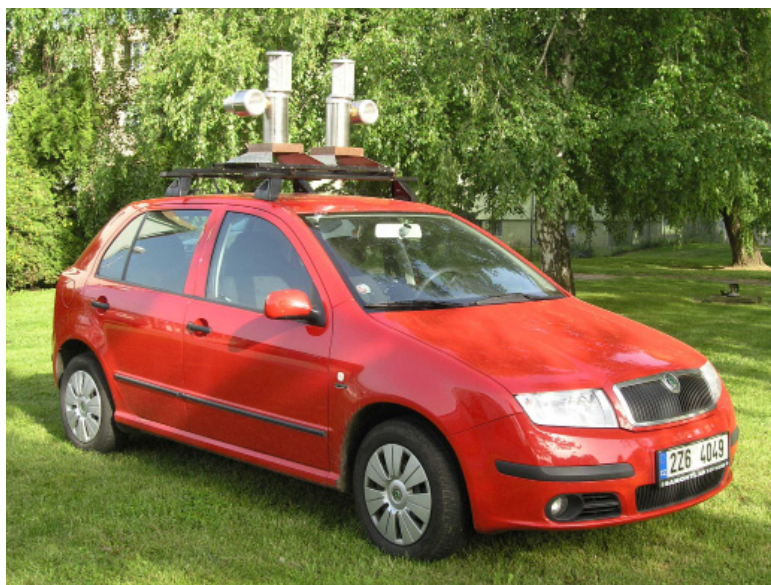
1: Automobil s fytopatologickým přístrojem pro odchyt spor z ovzduší 1: Automobile with fytopathological machine for collecting conidien in the air
