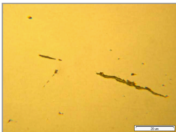
a – protáhlé siřníkové vměstky a – elongated sulphide inclusions
