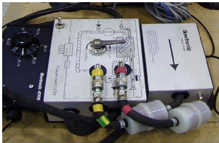
6: Průtokoměr Flowtronic 206 použitý při zkouškách
