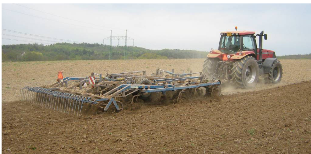
7: Traktor Case Magnum MX 285 v agregaci s kombinovaným kypřičem Köckerling Exaktgrubber – Vario
