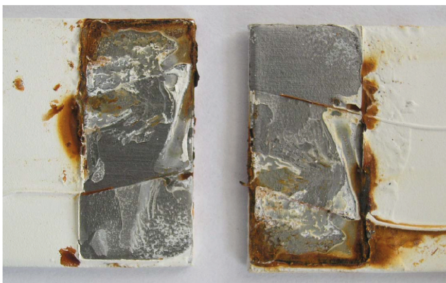
15: Vzorek po zkoušce na trhacím stroji, který byl vystaven 40 dnů prostředí H 2 O s antikorozi ochranou
