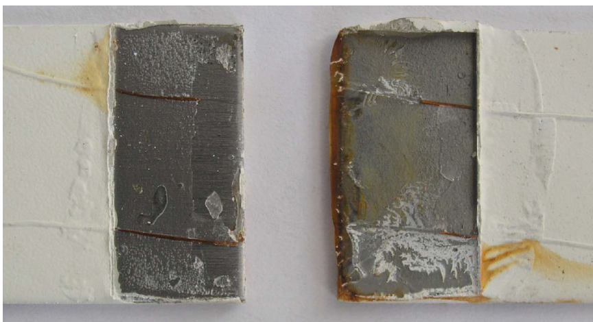
11: Vzorek po zkoušce na trhacím stroji, který byl vystaven 10 dnů prostředí H_2O s antikorozi ochranou
