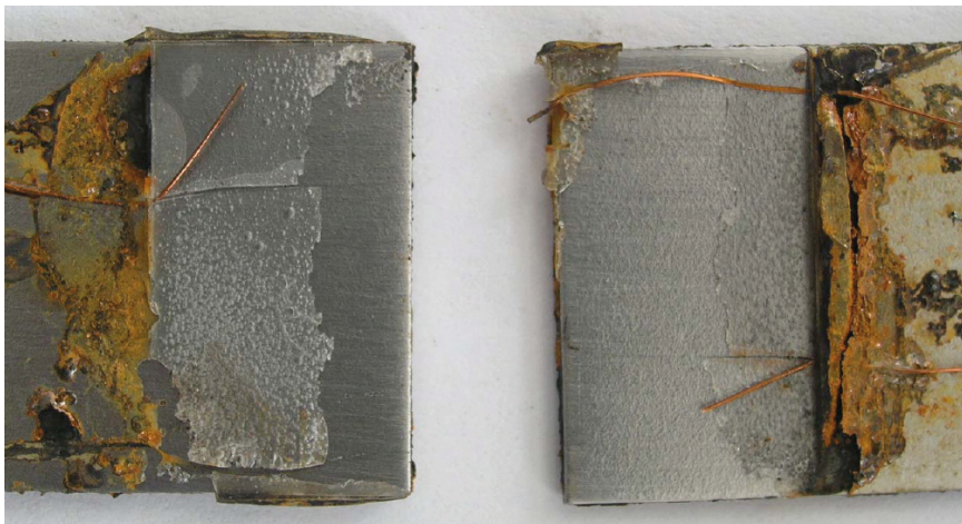
10: Vzorek po zkoušce na trhacím stroji, který byl vystaven 10 dnů prostředí H_2O bez antikorozi ochrany
