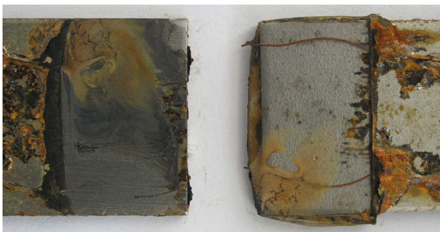
14: Vzorek po zkoušce na trhacím stroji, který byl vystaven 40 dnů prostředí H 2 O bez antikorozi ochrany
