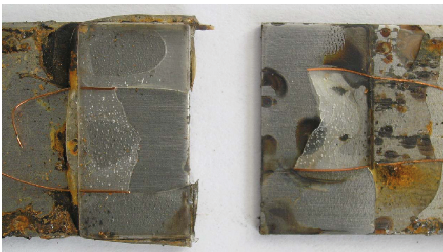
12: Vzorek po zkoušce na trhacím stroji, který byl vystaven 30 dnů prostředí H_2O bez antikorozi ochrany
