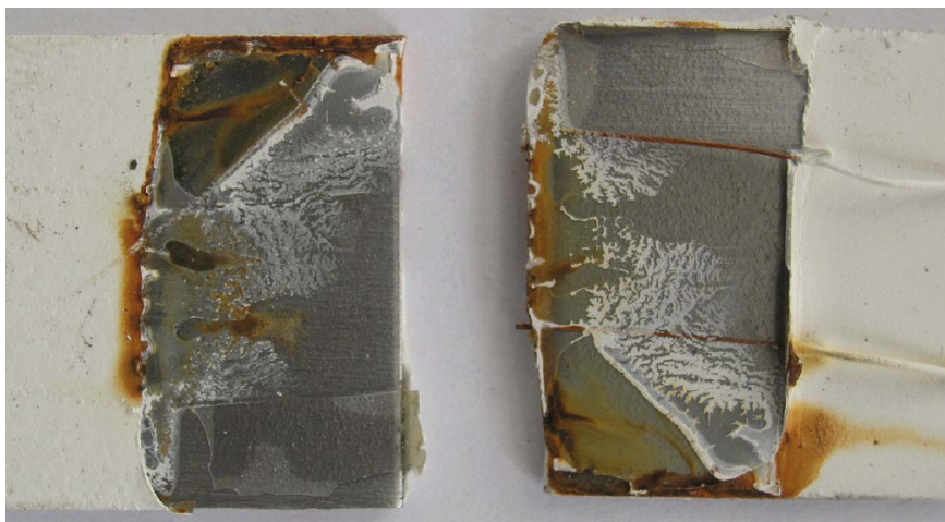
13: Vzorek po zkoušce na trhacím stroji, který byl vystaven 30 dnů prostředí H 2 O s antikorozi ochranou
