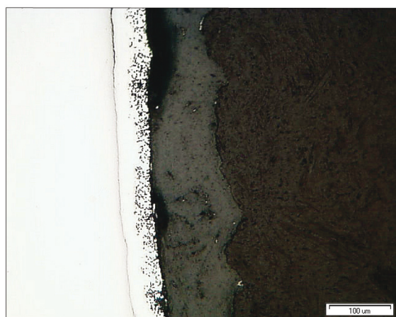
Komaxitová bariéra na povrchu zinku (14 dní NaCl)
